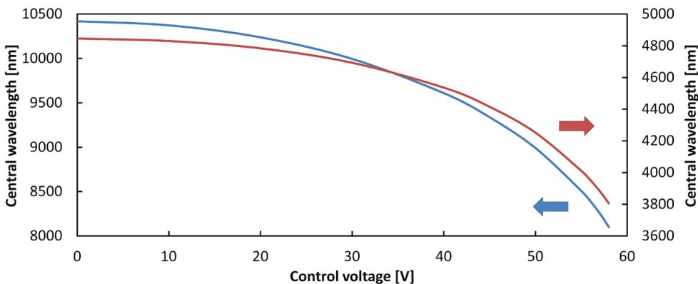
図2: デュアルバンドファブリ・ペロー干渉計の例において、波長範囲4 μm ~ 5 μm (赤の曲線) および8 μm ~ 10.5 μm (青の曲線) での、制御電圧と中心波長の関係
