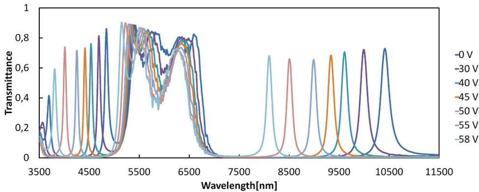
図1: 各種制御電圧で測定したデュアルバンドファブリ・ペロー干渉計の透過率スペクトル。波長は4 μm ~ 5 μm および8 μm ~ 10.5 μmを同時に使用できます。
