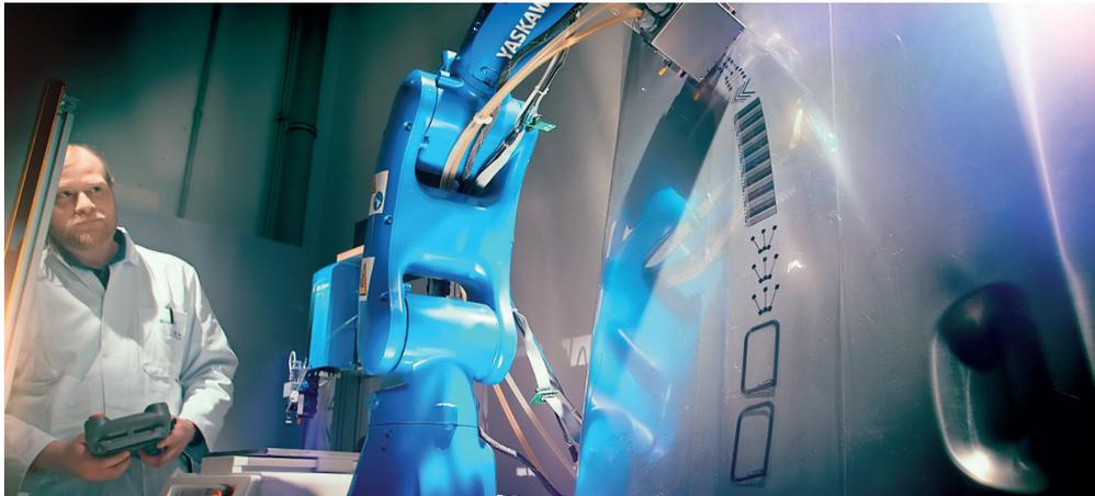
**Roboter-gestütztes Inkjet-Drucken auf 3D-Bauteilen am Fraunhofer ENAS.**
