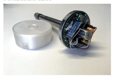
Der Werkstückträger mit Sensorsystem für Profilwalzmaschinen wurde gemeinsam mit dem Fraunhofer IWU entwickelt. Foto: Roman Forke, Fraunhofer ENAS
