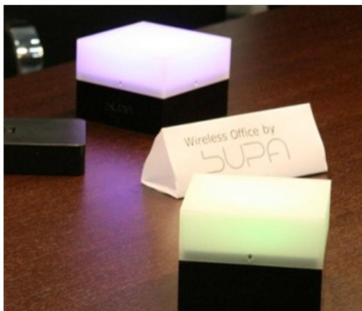
**Lichtelemente mit integrierter Empfängereinheit, die durch den mit der SUPA-Technologie ausgestatteten Konferenztisch drahtlos Strom empfangen.**
