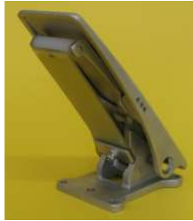
Gestickter Dehnungssensor in Gaspedal für „Drive by Wire“
