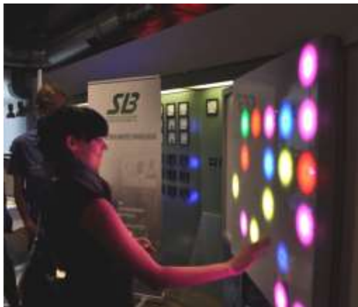
Reaktionswand tWall® plus mit gestickten Touchsensoren für die Physiotherapie
