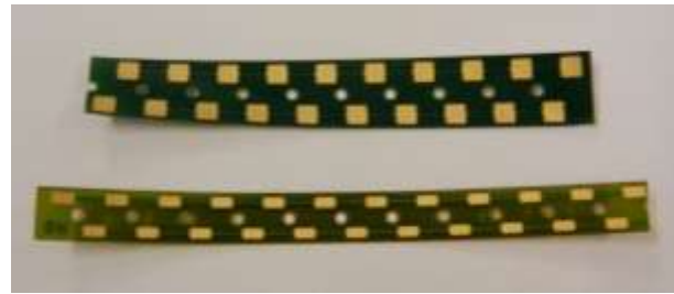
Flexible Leiterplatte (PCB) als Kontaktstützpunkt
