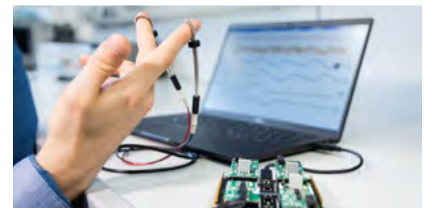
Fingerübung: Sensoren messen die elektrodermale Aktivität (EDA) der Haut, die unter anderem im Stressmonitoring eine Rolle spielen kann.
