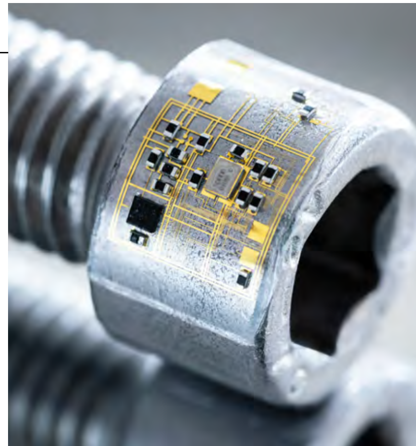
Flexibel einsetzbar: Hier wurde eine ultraflexible Leiterplatte auf dem runden Kopf einer Schraube fixiert.
