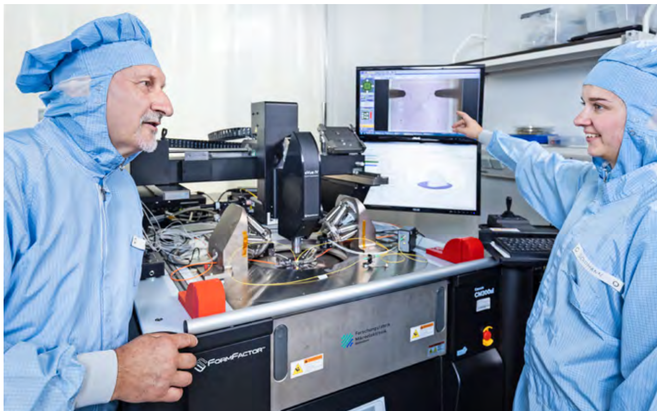
Steffen Kurth und Anne-Katrin Schumann, wissenschaftliche Mitarbeiterin am Fraunhofer ENAS, an einer Wafer-Testanlage. Hier werden photonische Komponenten, die zentral für Quantenchips kommen-der Generationen sind, analysiert.
