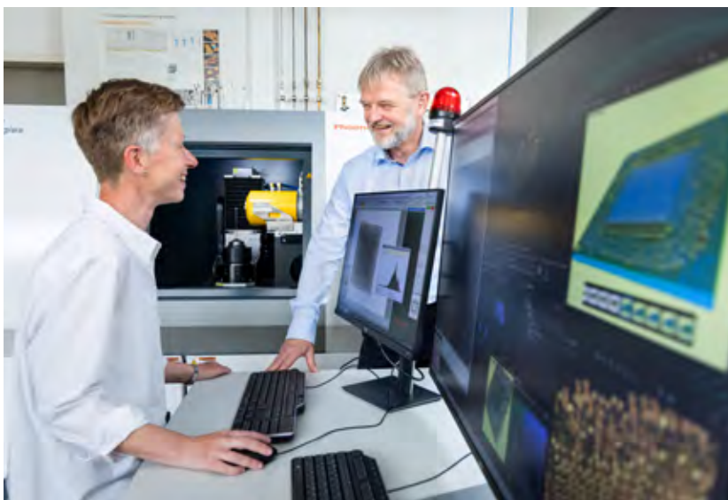
Elke Noack und Sven Rzepka werten die 3D-Röntgen-Computertomografie eines neuen elektronischen Bauteils aus.
