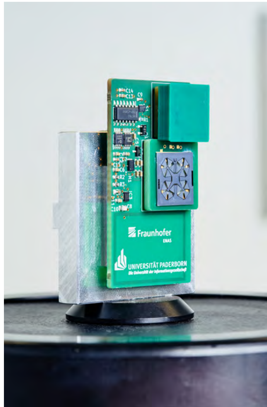
Mini-Power-Plant: Mithilfe dieses Systems zur Vibrationsdetektion mit Piezowandler und Memristor lassen sich künftig energieautarke smarte Sensoren für die Industrie 4.0 betreiben.
