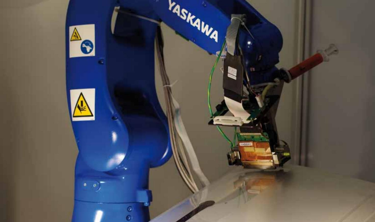
Herstellung von Funktionsschichten mittels 6-Achs-robotergestützter Inkjet-Drucktechnologie zur Herstellung von Kabelbäumen auf Fahrzeugteile.
