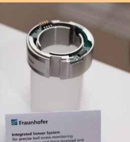
Integriertes Sensorsystem zur genauen Überwachung von Temperatur und Kraft in einem Kugelgewindtrieb.
