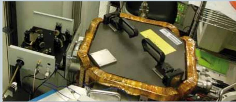
Schematische und fotografische Darstellung einer modifizierten Prozesskammer mit angeschlossener Multipassoptik (MPO) für die Plasmaanalyse mittels QCLAS.
