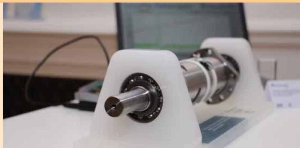
Kugelgewindtrieb mit integriertem Sensorsystem.
