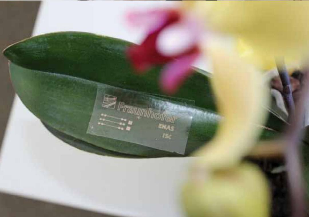
*Fraunhofer ENAS entwickelt im Rahmen des von der Fraunhofer-Gesellschaft geförderten Projekts »bioElektron – Biologisch abbaubare Elektronik für aktive Implantate« gemeinsam mit anderen Fraunhofer-Instituten biologisch abbaubare gedruckte passive und aktive mikroelektronische Komponenten.*
