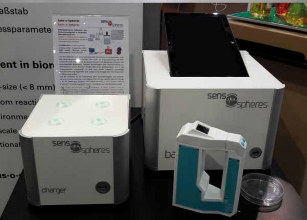
*Der Demonstrator der vom BMBF geförderte Entwicklung der Sens-o-Spheres zur neuartigen Messung in Bioreaktorsystemen.*
