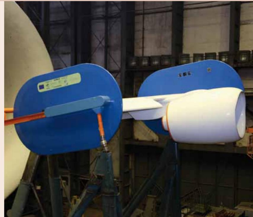
AFLoNext Windtunnel-Modell mit integriertem Synthetic Jet Aktoren Array.
