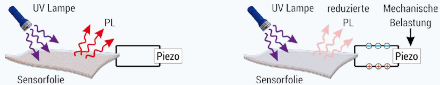
Sensorfolie mit Ausgangshelligkeit (links) und durch mechanische Belastung reduzierte Helligkeit der Sensorfolie (rechts).
