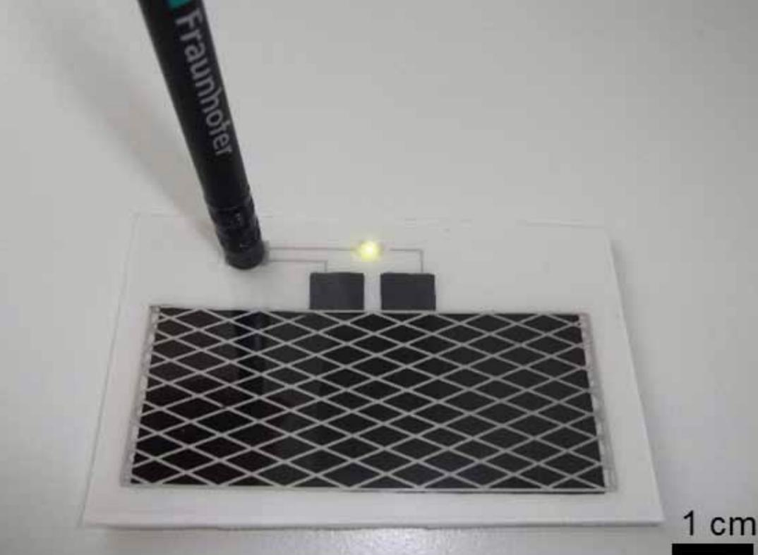
*Eine auf einem technischen Textil hergestellte Batterie treibt eine LED.*
