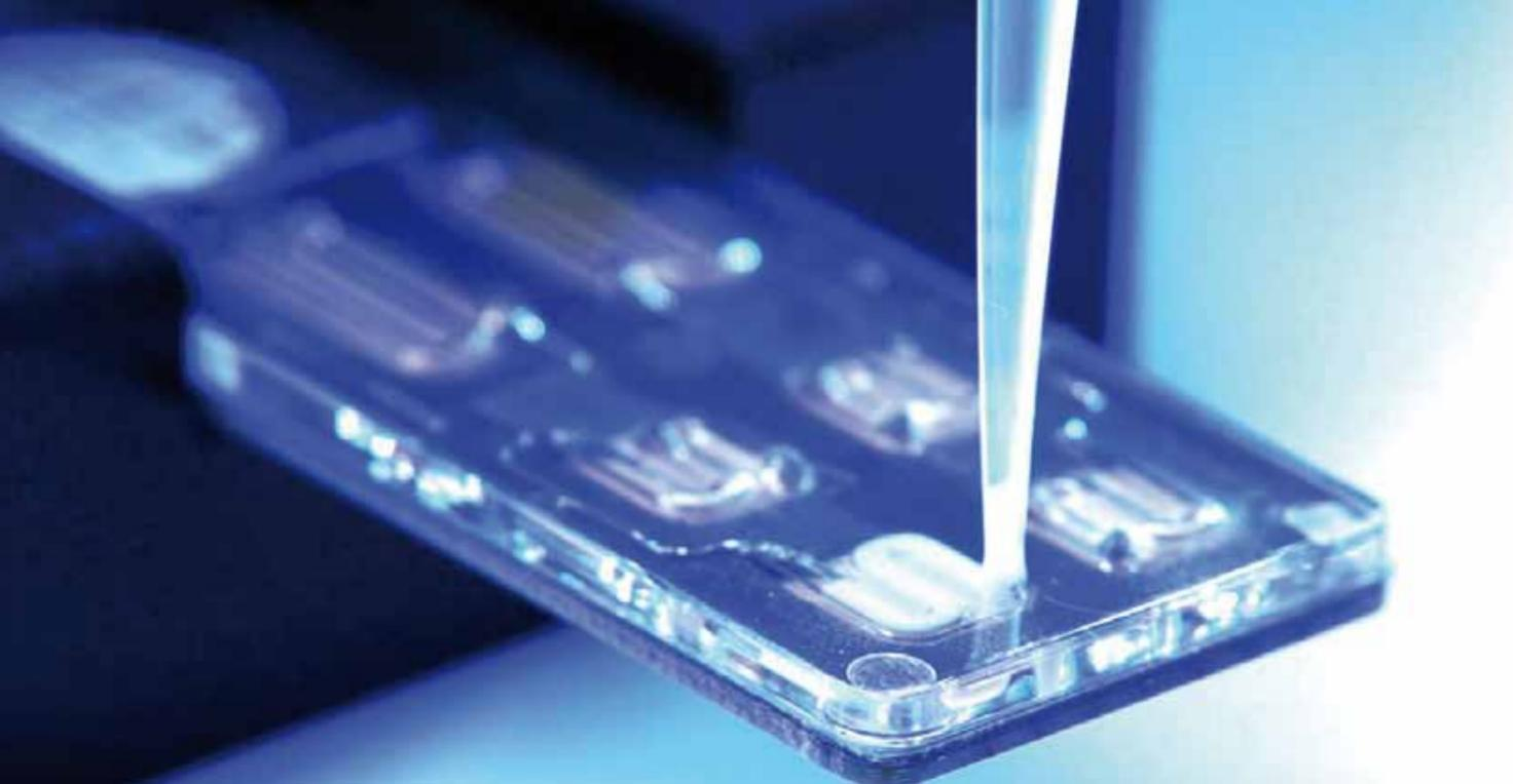
Eine Milchprobe wird zur Analyse in eine mikrofluidische Kartusche gefüllt.
