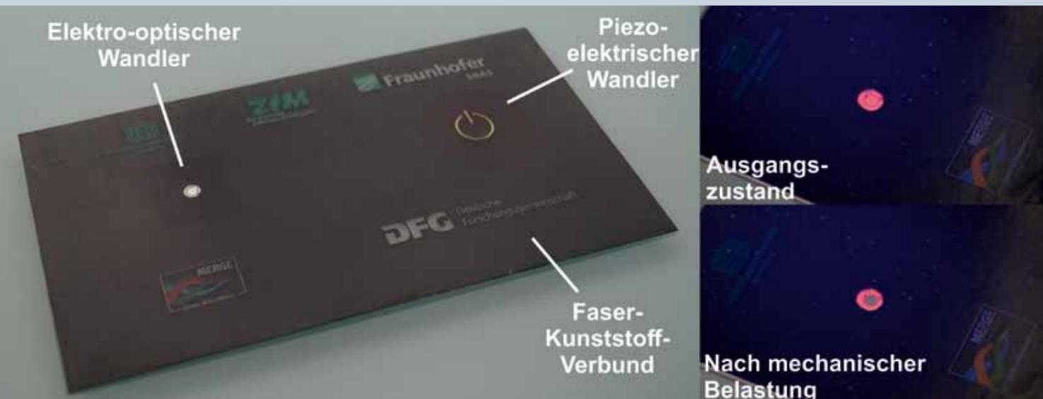
Sensorfilm (elektro-optischer Wandler) und piezoelektrischer Wandler integriert in Faser-Kunststoff-Verbund.
